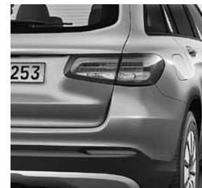
Grupos ópticos traseros en técnica de diodos luminosos (LED)
